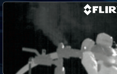
六フッ化硫黄漏れの光学ガス画像
