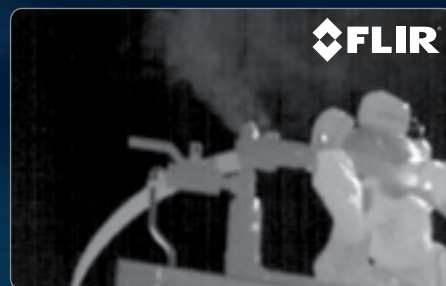
一酸化炭素漏れの光学ガス画像
