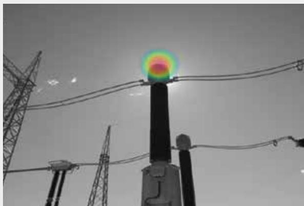
FLIR Si124のような音響カメラにより、電力会社は、部分放電パターンの解析、自動化された漏電コスト見積と放電タイプの分類による修理の優先順位決定、非接触検査の迅速かつ安全な実施が可能になります。
