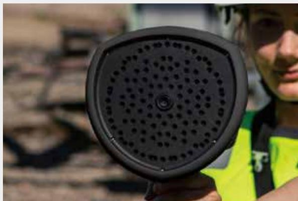
部分放電の箇所を特定して解析するAI搭載のプリセットを備えたFLIR Si124の周波数レンジとマイクグリッドは、干渉雑音を自動的に除去できるように最適化されています。
