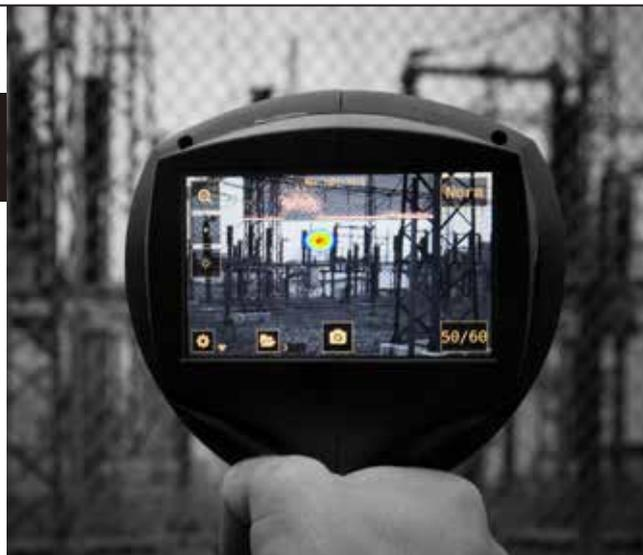
音響カメラの活用により、高電圧の設備のPD/コロナ放電の発生による設備の故障とダウンタイムを最小限に軽減
