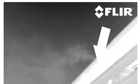
溶鉱炉内の一酸化炭素ガス漏れ
