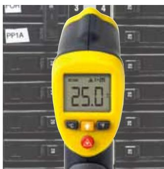
赤外線放射温度計:単一点の温度を測定する
