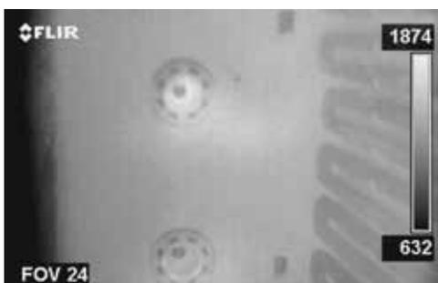
熱画像: FLIR GF309は炎を透かして撮影できる炎フィルタを内蔵しており、炎越しの温度計測も可能
