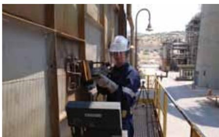
FLIR GF309は産業炉やボイラーの検査に幅広く使用されています。高温(最高+1,500°C)の炎を透かして見る事ができる炎フィルタを内蔵しており、炎越し検査に最適です
