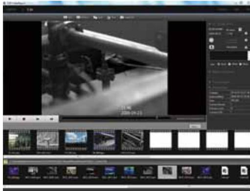
フリーシステムのガス検知用赤外線サーモグラフィには、ソフトウェアFLIR VideoReport (ビデオレポート) が付属します。FLIR VideoReportはビデオクリップ付のレポートを作成するソフトウェアです。FLIR GFシリーズで撮影したビデオクリップを編集し、ドラッグ&ドロップで簡単にレポートを作成できます。不要なシーンの削除も簡単にでき、気に入ったシーンだけで構成されたビデオクリップを作成できます。
