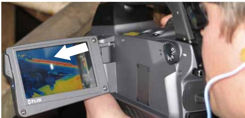
内蔵LCDスクリーンに表示されたガス漏れのリアルタイム映像
